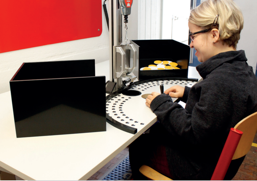
Die ergonomischen Arbeitstische werden in verschiedenen Varianten von den Caritas-Werkstätten Westerwald-Rhein-Lahn in Eigenregie konstruiert und sollen „Arbeit EINFACH machen“. Dieses Modell etwa verfügt unter anderem über taktile Führungen, die zum Leiten von Bauteilen dienen. Dies befähigt insbesondere blinde und sehbehinderte Menschen zum selbstständigen Arbeiten.
